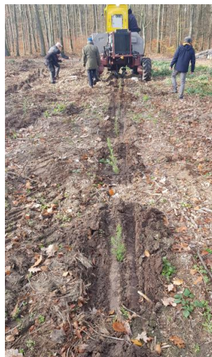
Rys. 1. RoboFoR – robot do leśnych prac odnowieniowych: a - wirtualny model bryłowy CAD-3D, b – testy prototypu w warunkach rzeczywistych.
